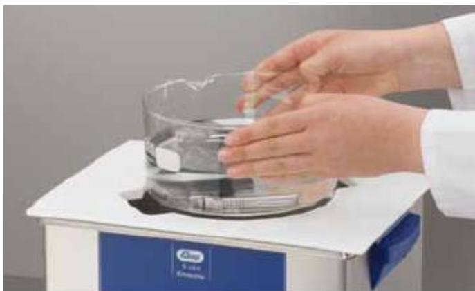
Víko s otvorem vyrobené z PP
